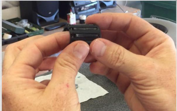
**SHOULD SOME NEEDLE BEARINGS POP OUT OF THE BEARING SLEEVE, JUST GENTLY PUSH THEM BACK INTO PLACE BY ROLLING THE BEARING SLEEVE AROUND WITH YOUR FINGER TIPS.**
